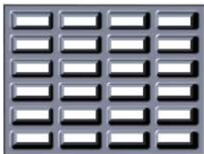
Konische Bodenöffnungen entwässern die 24 Sandtaschen pro Wabe
