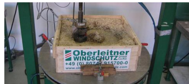
Kalottentest zu Verformbarkeit/Dauertrittbelastung
